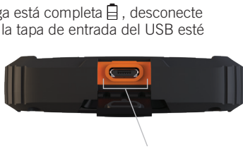
Puerto con entrada USB para carga/datos
