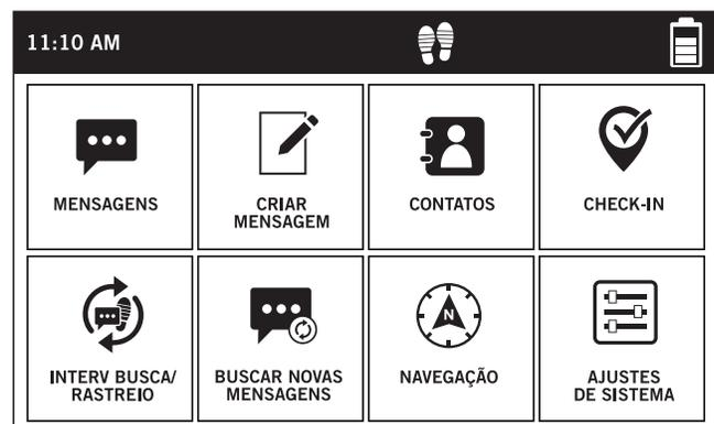
2. Assim que sua posição GPS for obtida, o SPOT X enviará suas posições de acordo com o intervalo de rastreamento que você selecionou, até que você manualmente interrompa o rastreamento, o SPOT X não detecte movimento, ou você desligue o dispositivo.
