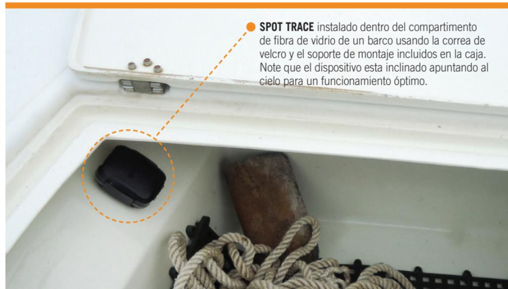
● **SPOT TRACE** instalado dentro del compartimento de fibra de vidrio de un barco usando la correa de velcro y el soporte de montaje incluidos en la caja. Note que el dispositivo esta inclinado apuntando al cielo para un funcionamiento óptimo.
